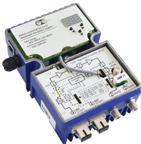
**MOB-729** - это современный модульный оптический приемник, предназначенный для работы в сетях с архитектурой FTTH. Имеет функцию резервирования одного или двух оптических входов. Приемник оснащен непрерывной регулировкой передачи сигнала. Встроенная система АРУ поддерживает постоянным высокий выходной уровень RF сигнала.
